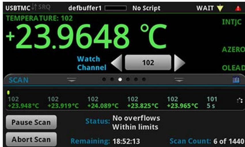
2. 如果 USB 闪存驱动器上有数据并且您希望在完成前查看此数据，请暂停扫描，取下驱动器，将数据文件复制到 PC，将驱动器重新插入 DAQ6510，然后重新开始扫描。
