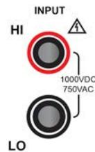
使用 INPUT HI 和 INPUT LO 端子进行除电流外的所有测量。
