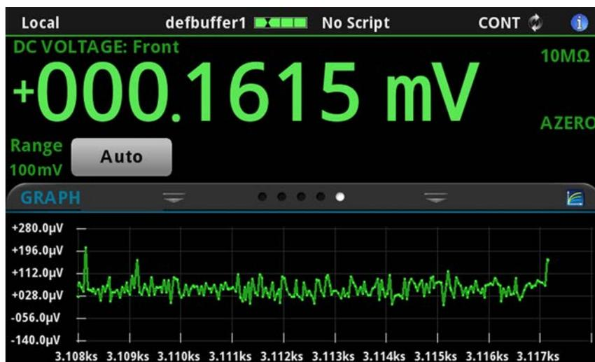
要以全屏查看图形并访问图形设置，请选择滑动屏幕标题右侧的图形图标。也可以通过按 **MENU**（菜单）键并在 **Views**（视图）下选择 **Graph**（图形）来打开完整功能 **Graph**（图形）屏幕。
